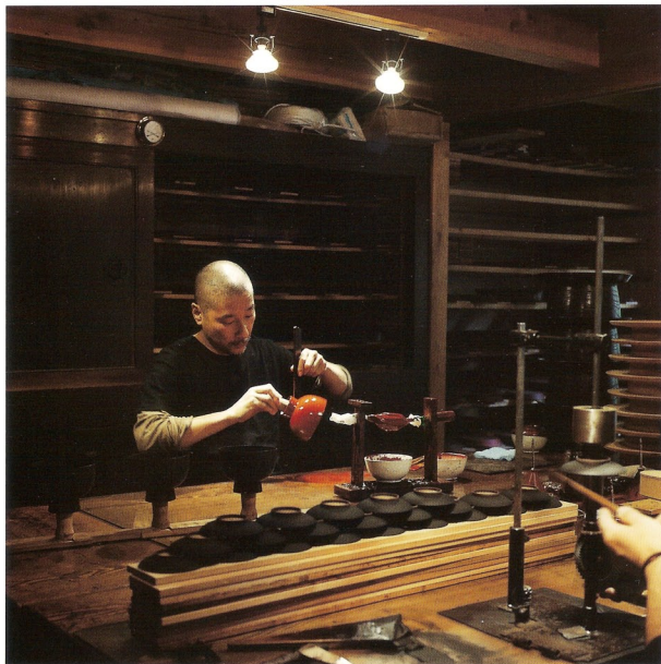
自宅を兼ねた工房で、塗りを施す。1階で、主に下塗りを行い、仕上げの上塗りは、埃をシャットアウトした2階の専用工房で行う。
